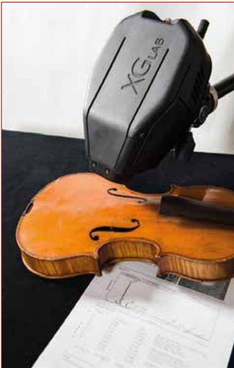
Ultralleggero: la testa pesa solo 2 kg e al suo interno si trovano tutti i componenti principali, quali il tubo a raggi X, il rivelatore SDD, una telecamera con luce LED, un sistema di allineamento basato su due laser.
