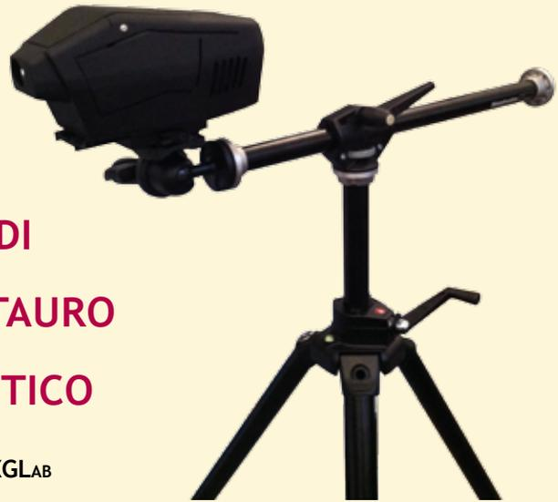
Un innovativo spettrometro portatile basato sulla tecnica EDXRF è stato progettato da XGLab per analisi in-situ, veloci, non-distruttive e non-invasive in tutti gli ambiti specifici dello studio di opere d'arte, per la ricerca sui materiali e l'analisi elementare in genere.
