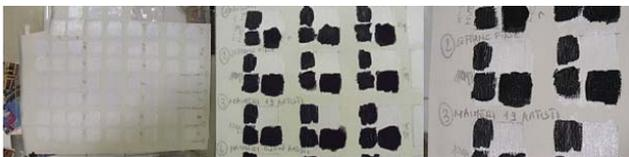
Figura 8 (a,b,c) - a) applicazione del bianco di zinco per ogni tassello; b) sovrapposizione dei neri d'avorio dopo 15 gg; c) dettaglio.
