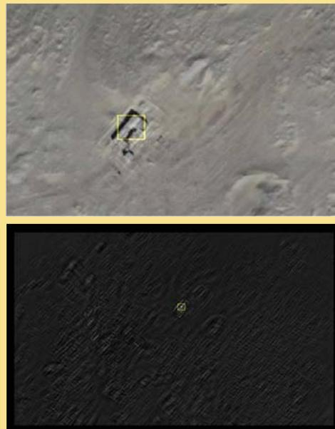
Figura 5 - Esempio dell'applicazione dell'algoritmo optimal edge su immagine pancromatica Ikonos (Fayoum, Egitto) e corrispondente detection layer.
