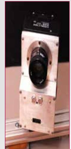
Fig. 1 - Camera CCD multispettrale.
