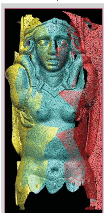
Figura 4 - Elaborazione del dato laser proveniente da più scansioni evidenziate con colori diversi durante la fase dell'allineamento e della registrazione.
