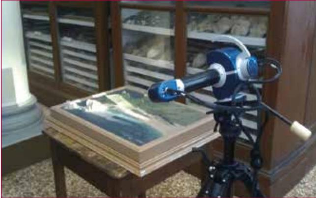
Fig. 1 - Scansione a luce strutturata di plastico di area costale del XIXo secolo.
