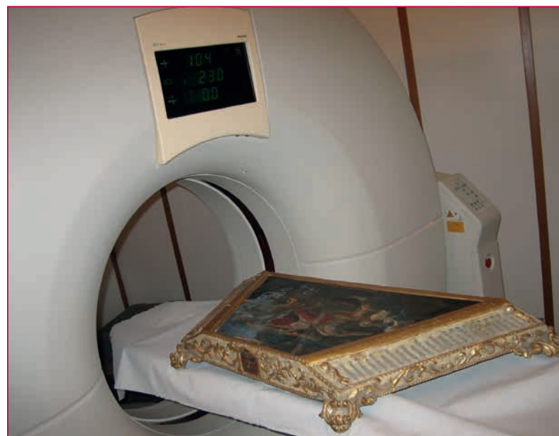
Fig. 8 - Tomografia assiale computerizzata mediante sistema Philips Brilliance 64.
