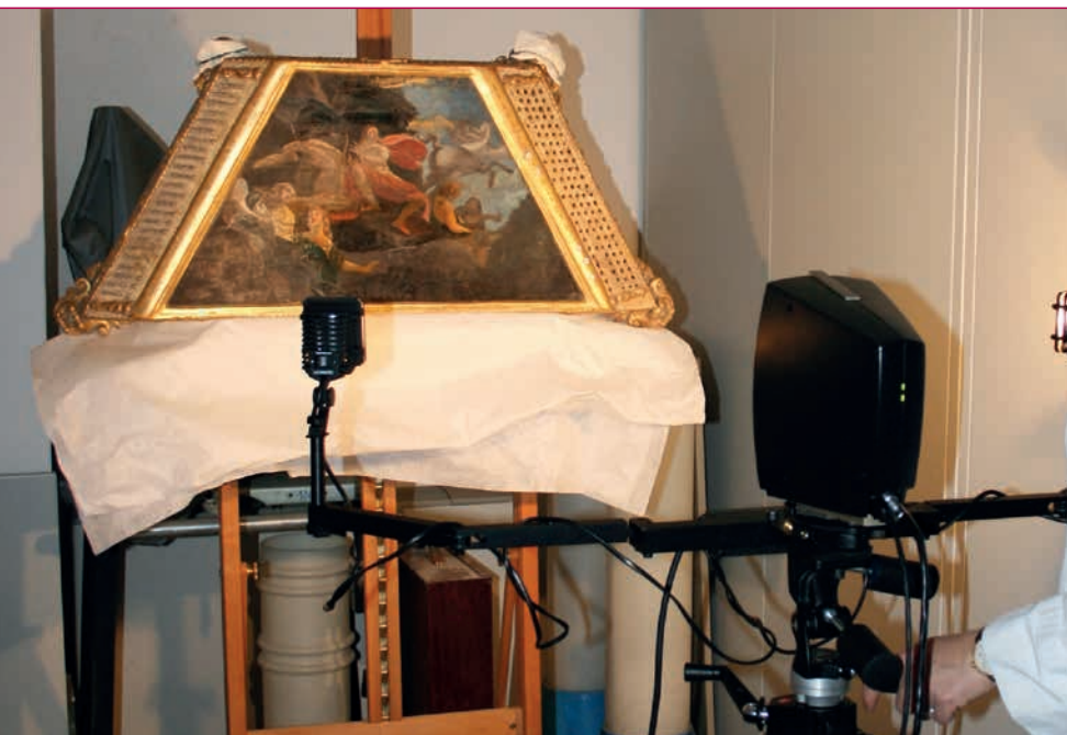
Fig. 2 - Imaging multispettrale mediante camera Artist con sistema di posizionamento CPS100.
