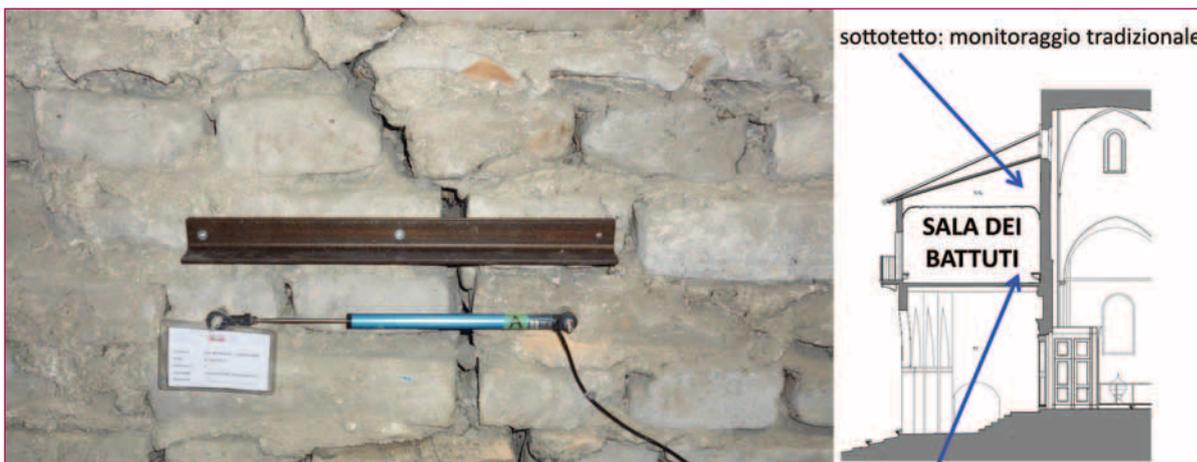
Fig. 4 - Monitoraggio mediante trasduttori di spostamento e sezione di dettaglio del posizionamento.
