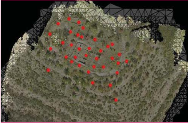
Fig. 8 - Visualizzazione in ArcGIS di: ortofoto Agisoft Photoscan, file dei GCP, geometria Meshlab.
