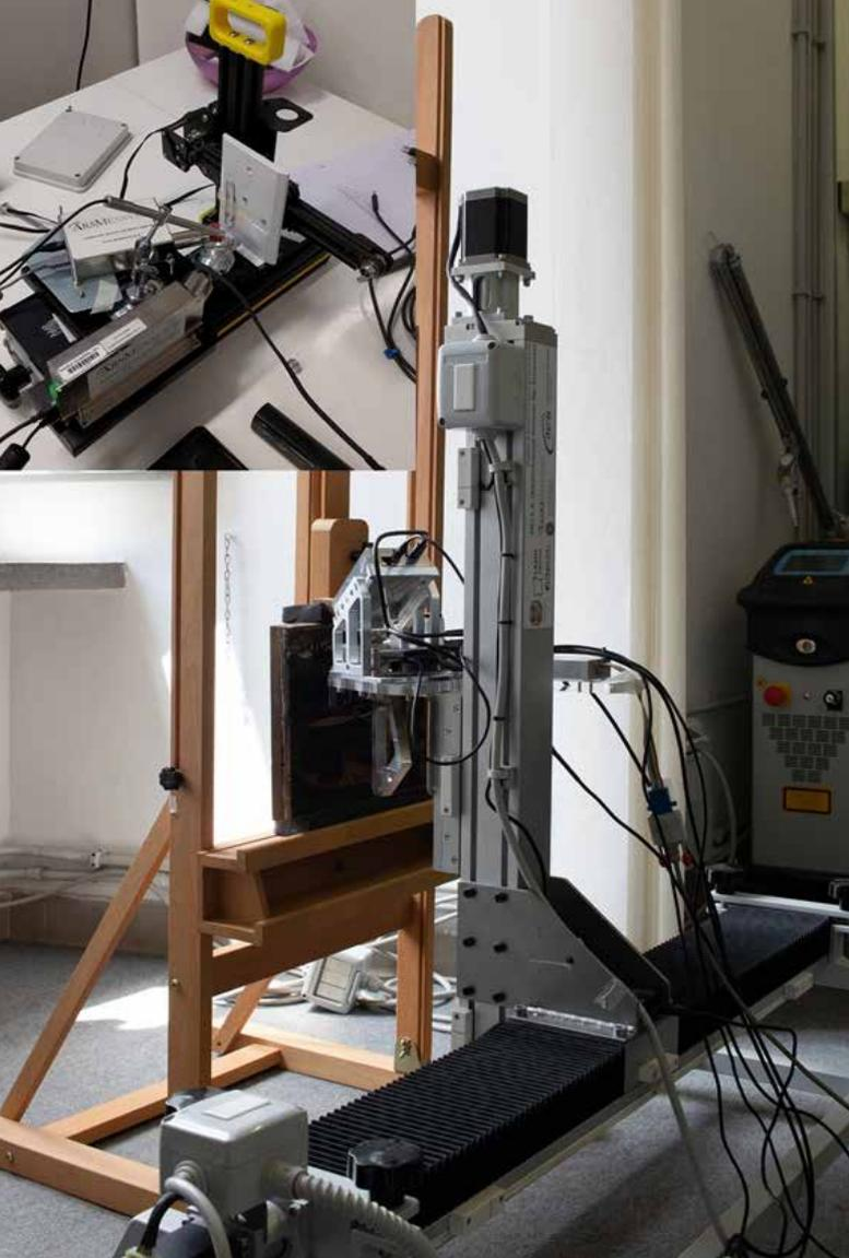
Fig. 4 - Lo scanner è composto da diversi moduli, come mostrato in figura. Il più ingombrante è il sistema di scansione le cui dimensioni possono essere ridotte moltissimo, se si fa la scansione di un oggetto piccolo (vedi il riquadro in alto a sinistra).
