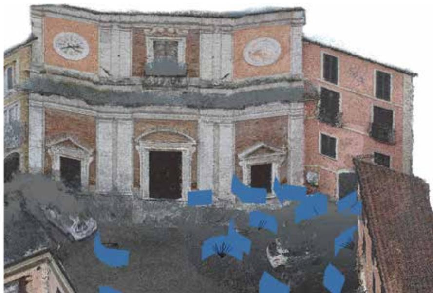
Fig. 3 - Acquisizione Sfm (Structure From Motion).
