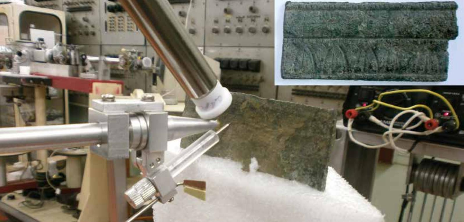
Fig. 4. Frammento di lamina decorata (inv. n. 1870) dagli scavi di *Tifernum Mataurense*, durante l'analisi effettuata mediante PIXE.
