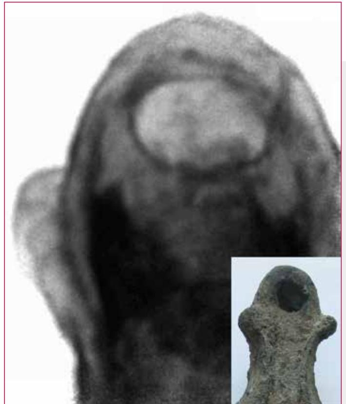
Fig. 6 - Una delle sei estremità della lampada polilicne: immagine da RN confrontata con vista esterna.
