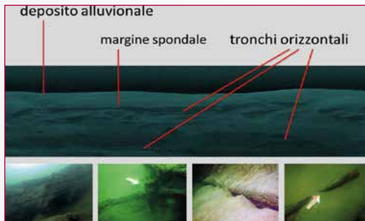
Fig. 5 - Lago Tramonto, Gambulaga (FE). Immagine da echo-side scan sonar aperta con Humviewer e 4 immagini relative al margine spondale: strati di argilla compatta, palo infisso verticale, tronco orizzontale in piano, tronco in seconda giacitura (Foto Autore 2016-2018).
