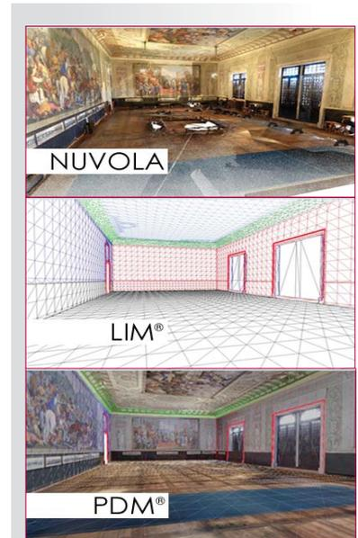
Figura 3 - Sala della Vittoria - Nuvola di punti colorata, Lidar Information Model e Photo 3D Model.
