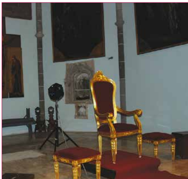
Fig. 14 - Carinola (CE), cattedrale, interno, rilievi acustici, cassa omnidirezionale (sorgente) collocata nello spazio absidale.
