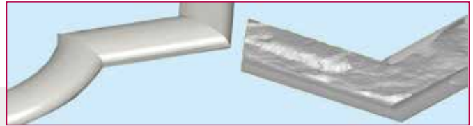
Fig. 8 - Rilievo del bordo mancante - Superficie esterna (da modello originario) e Superficie interna complementare alla superficie rilevata.
