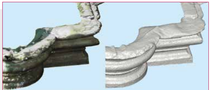
Fig. 6 - Rappresentazione spaziale della superficie rilevata con i colori propri e "neutra".
