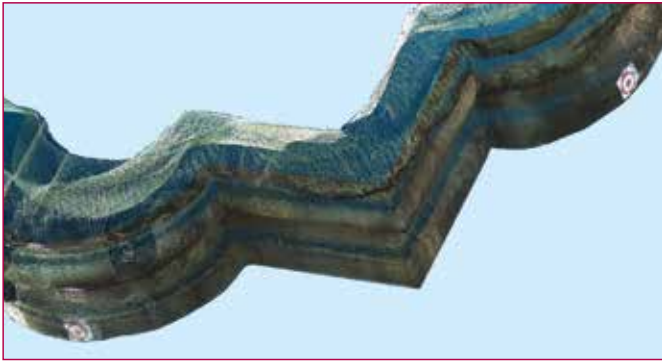
Fig. 7 - Nuvola punti da rilievo con Laser Scanner 3D.
