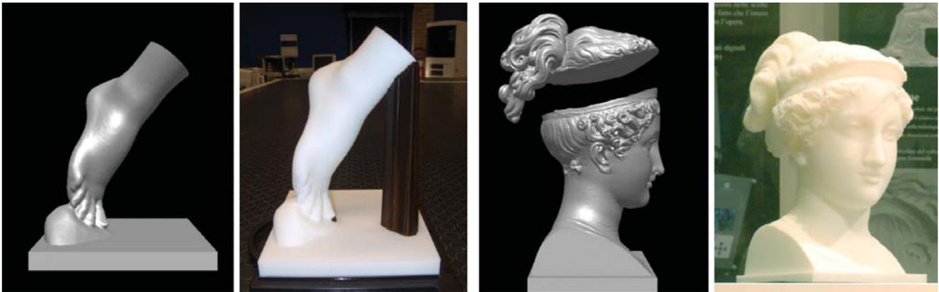
Figura 8 - A sinistra: modello digitale del piede destro e modello fisico prima dell'operazione di lavaggio (è visibile il materiale scuro di supporto depositato durante il processo di stampa). A destra: suddivisione del modello digitale della testa (seguendo l'andamento della fascetta che cinge i capelli) e modello fisico esposto presso i Musei San Domenico.
