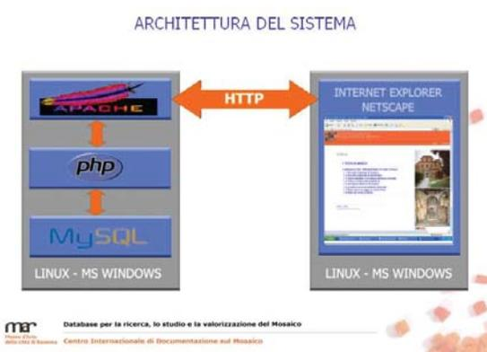
Figura 2 - Schema dell'architettura del sistema informativo sulle decorazioni musive.
