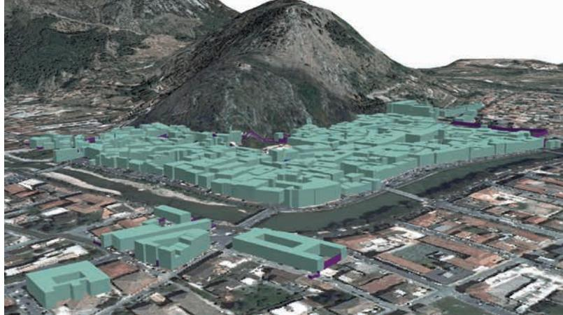
Fig. 11 - DTM e ortofoto con estrusione dei layers.
