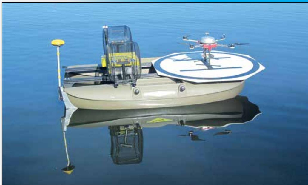
Fig. 3 - La più recente innovazione di aerRobotix è rappresentata dalla sperimentazione dell'impiego simultaneo del drone marino CatOne, impegnato nel rilievo batimetrico, con quello di un drone multicottero «imbarcato», adibito al rilievo fotogrammetrico delle zone costiere dei bacini. In tal modo si assicura la continuità della mappatura sopra e sotto il pelo dell'acqua.
