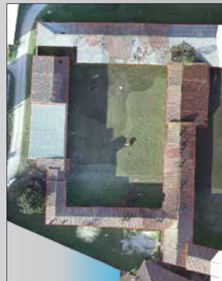
Fig. 2 - Restituzione dei tetti sovrapposta all'ortofoto.
