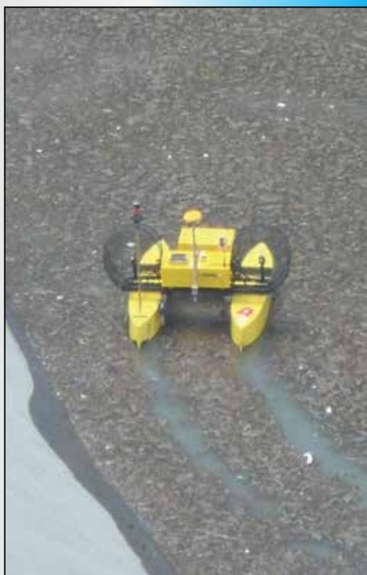
Fig. 2 - Uno dei prototipi di CatOne in navigazione su un bacino idroelettrico in presenza di uno spesso strato di detriti portati a valle dall'immissario.
