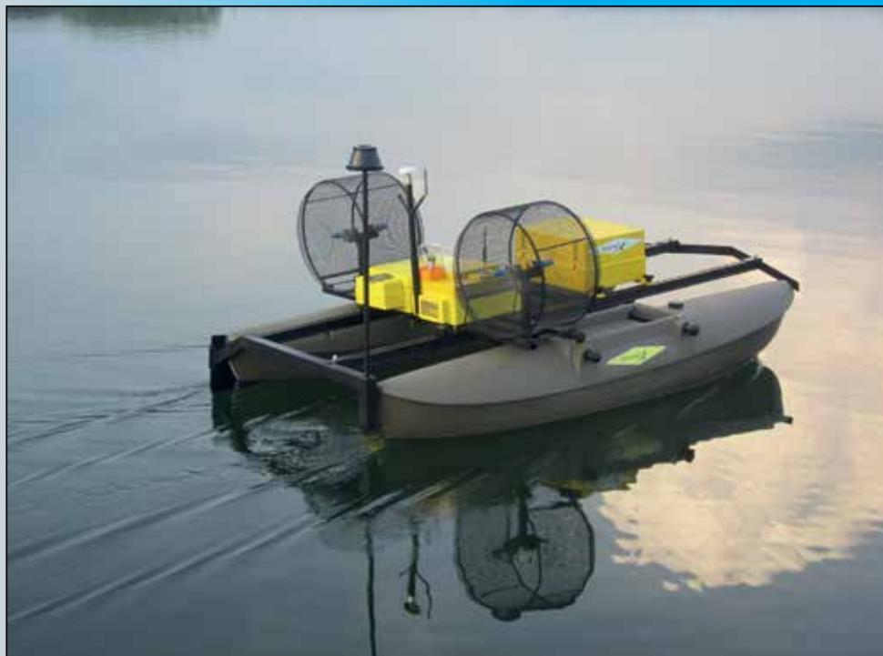
Fig. 1 - La configurazione base della versione CatOne HD4. Si nota la presenza di due coppie di motori e relative eliche aeree controrrotanti.
