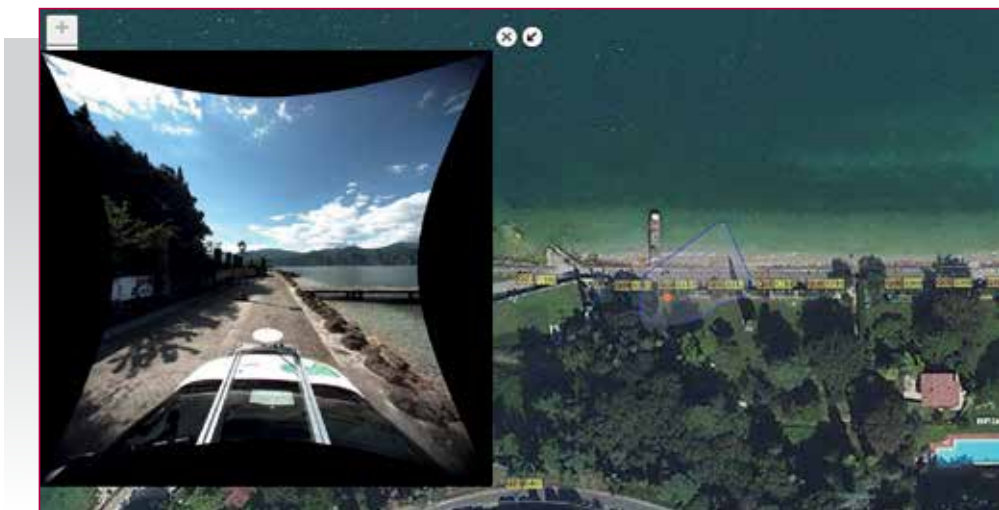
Fig. 3 - Il lavoro in ufficio: si verifica la posizione dei punti luce con l'ausilio delle immagini digitali a 360°.
