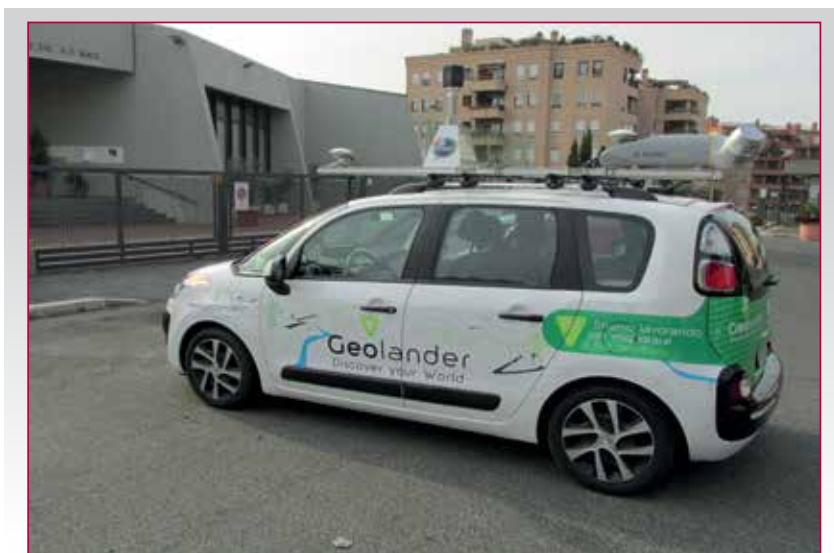
Fig. 2 - Il Geolander di Gemmlab nella sua interezza: il sistema di imaging spaziale Trimble MX2, la video camera LadyBug a 360° ed il sistema inerziale GNSS Trimble AP20.
