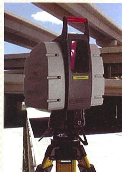
Fig. 2 - Il nuovo sistema laser scanner HDS 3000 di Leica Geosystems.
