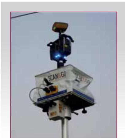
Fig.4b - Dettagli del dispositivo autolivellante.
