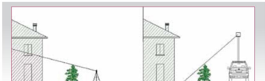
Fig. 2 - Zone di sottoguardo dovute alla presenza di ostacoli.
