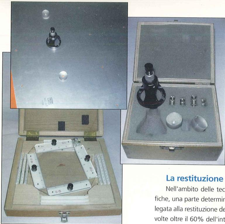
*Gli strumenti per il disegno in coordinate del topografo dei primi anni '80: la lastra parametratrice in materiale invar, il puntinatore e il coordinatografo*
