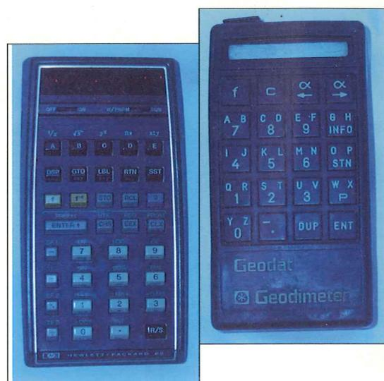
*I primi sistemi avanzati per la memorizzazione dei dati e il calcolo. Il famoso Geodät della Geotronics (1980) e la HP65 (1978) che permetteva di programmare e memorizzare su scheda un set limitato di istruzioni di calcolo*
