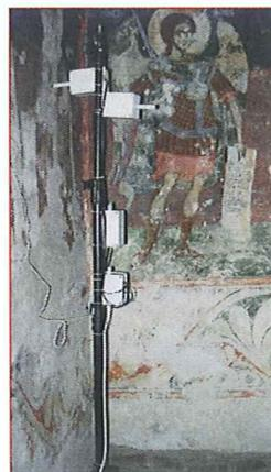
Qui sopra, la disposizione dei sensori di rilevamento del microclima interno ed esterno al Patriarcato. A sinistra, particolare dei sensori di temperatura ed umidità relativa e temperatura a contatto sulla superficie installati nel Patriarcato sulla superficie affrescata (particolare della zona di San Demetrio)
