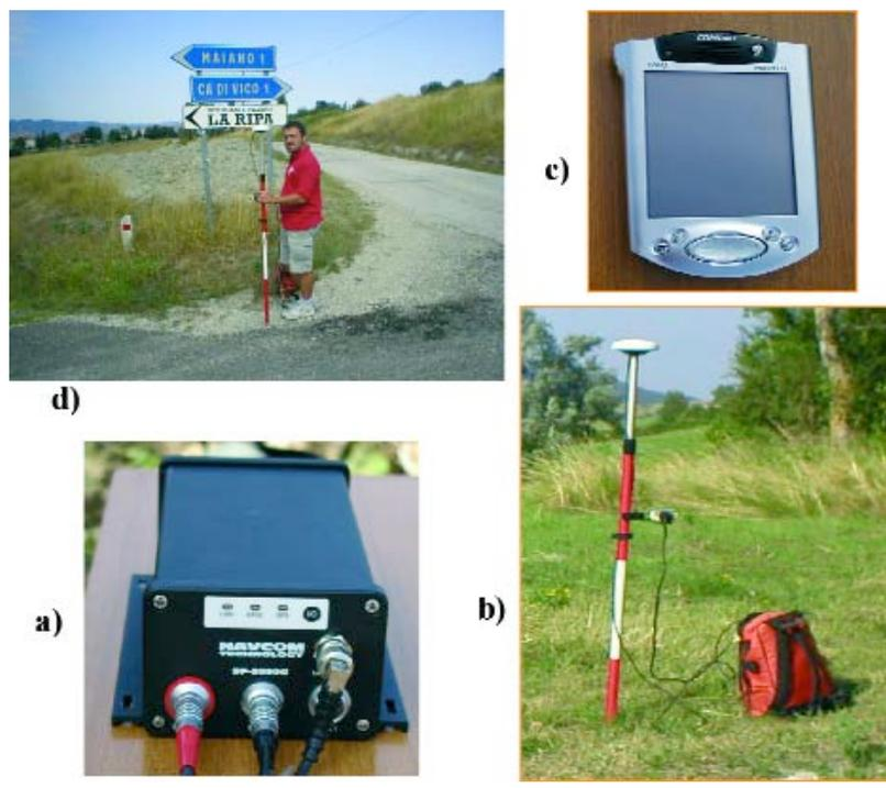
Figura 14 - La strumentazione utilizzata. a) ricevitore; b) antenna; c) palmare. d) Immagine delle misure.
