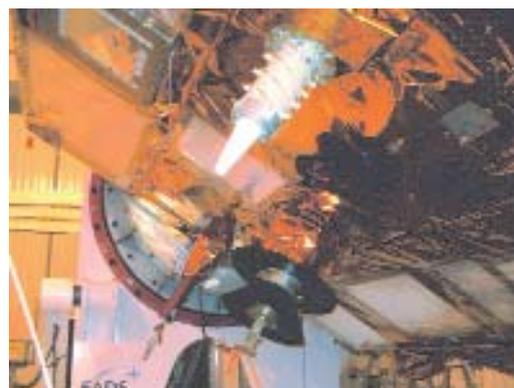
Antenna del sistema DORIS a bordo del satellite CryoSat
