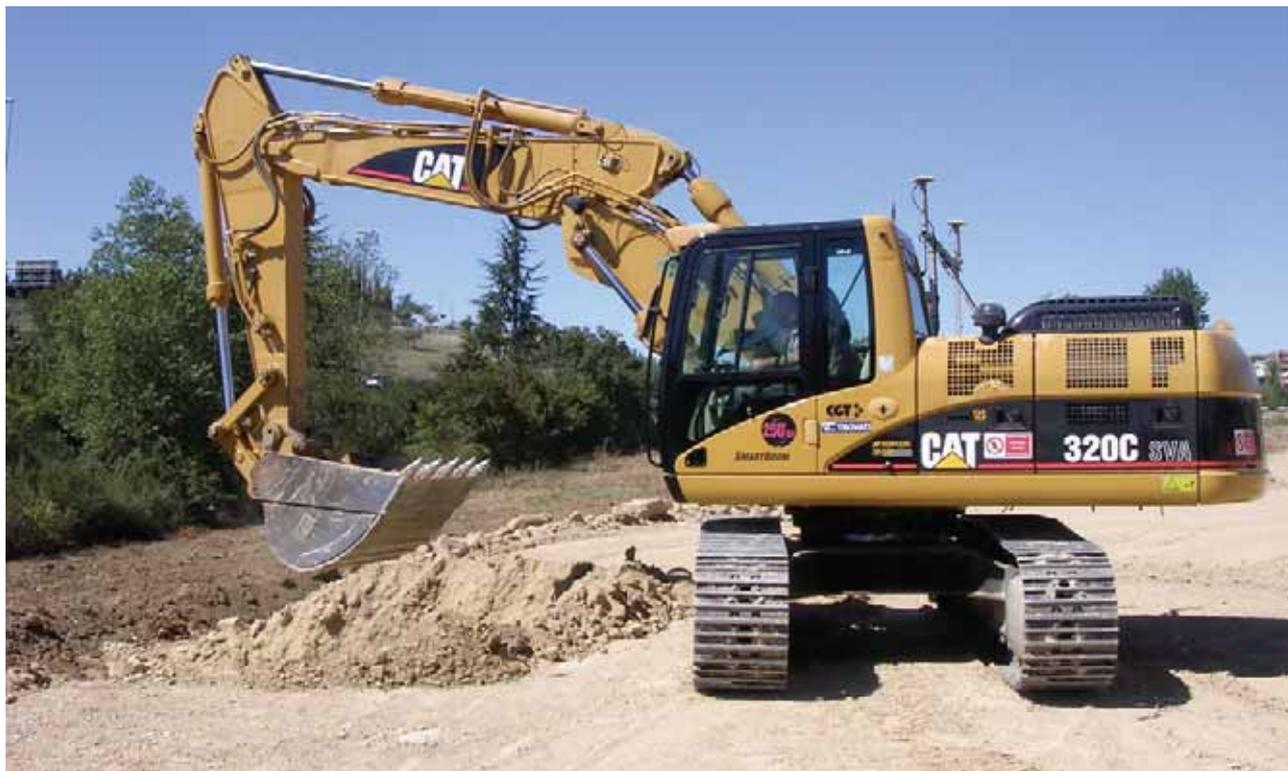
Sistema Topcon 3DXi montato sull'escavatore CAT 320C dell'impresa F.Ili Trovati
