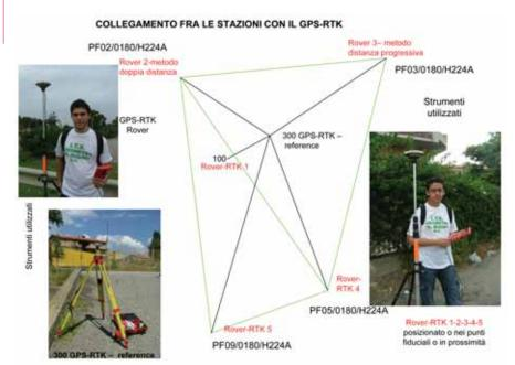
poligonale. Sono stati poi rilevati, con l'ausilio di ulteriori stazioni integrative, quattro punti fiduciali catastali, i quali collegati tra loro, formavano due triangoli contenenti al loro interno l'edificio oggetto di misurazione.
