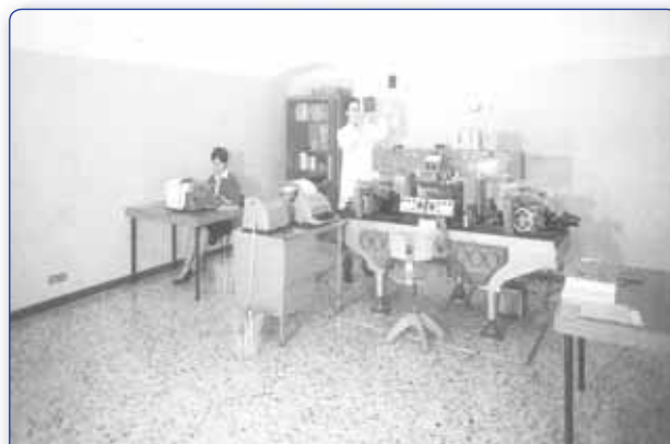
Figura 3 - Lo stereocomparatore TA-3, installato nell'Istituto di Topografia e Fotogrammetria del Politecnico di Milano.
