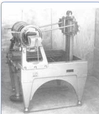
Figura 12 - Il Fotostereografo Alfa, a proiezione ottico-meccanica.
