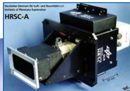
HRSC-A Line sensor prodotto da DLR per la Mars96 mission successivamente adattato per applicazioni aeree
