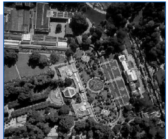
Ricostruzione della immagine in proiezione centrale dai 4 sensori nella DMC tratto da: Jeff Lower and Jeremy Conner, Photogrammetric Mapping With the Z/I Digital Mapping Camera (DMC), 3001 Inc.
