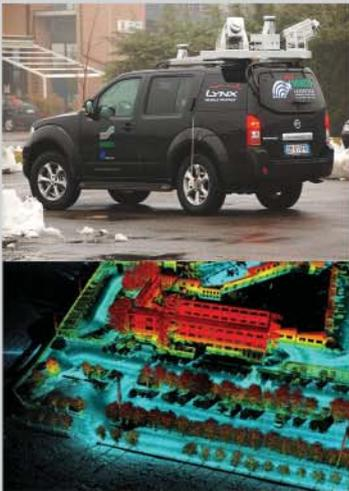
Fornito il primo esemplare al mondo del Lynx, il Lidar studiato espressamente per il Mobile Mapping, per il quale abbiamo collaborato alla progettazione.
