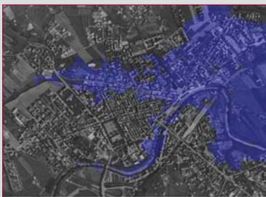
**Figura 3b-** Simulazione di esondazione con altezza idrometrica di m 136,30 s.l.m. corrispondente alla fase di esercizio di tutte le opere di sistemazione idraulica sull'asta fluviale
