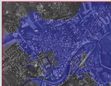
**Figura 3c-** Simulazione di esondazione con altezza idrometrica di m 138,29 s.l.m.
