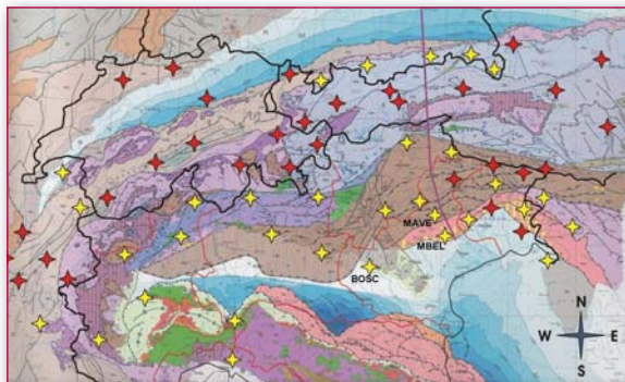
Figura 1: La rete GPS – in rosso le stazioni esistenti, in giallo le stazioni realizzate con il progetto
