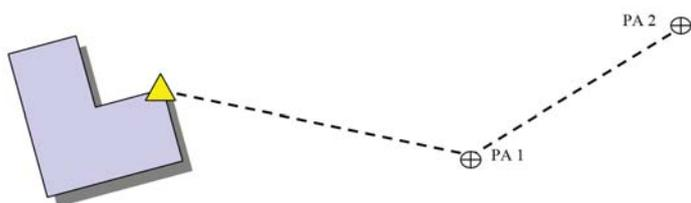
Figura 2 - Schema di determinazione con stazioni ausiliarie.
