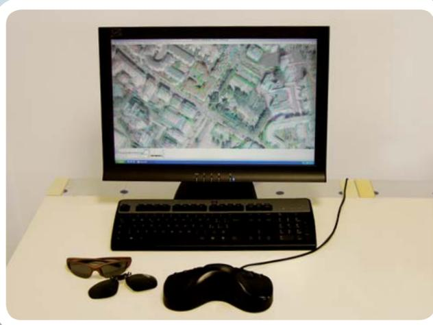
ArcGDS è basato su una tecnologia consolidata e collaudata, perché impiegata da oltre 10 anni all'interno dei prodotti di fotogrammetria digitale di Geosoft, inoltre è compatibile con i sistemi di visione stereoscopica più diffusi, basati su schede grafiche OpenGL *stereo ready*, ma può essere utilizzato con successo anche con i nuovi monitor stereoscopici *low cost* di iZ3D.
