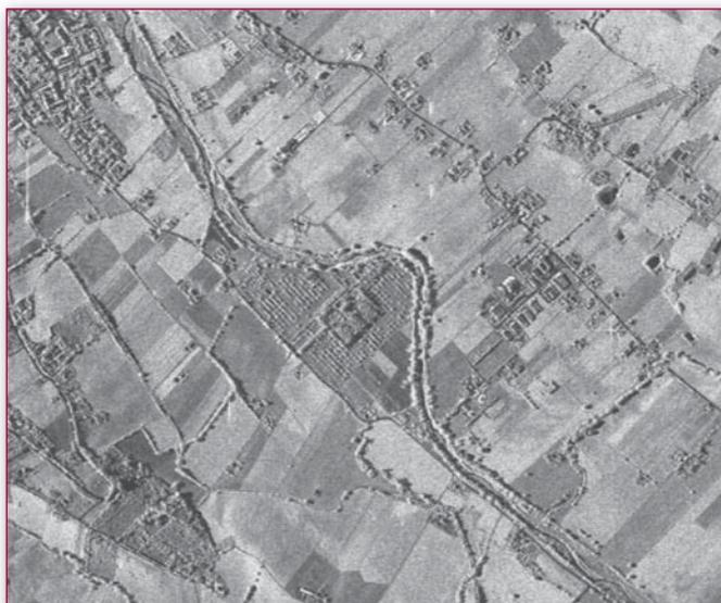
Figura 2 - COSMO Spotlight\_2 del 17 novembre 2008 zona Macerata - (descending orbit, right looking, horizontal polarization, incidence angle 54.66°) da notare la capacità di identificazione delle singole caratteristiche agronomiche
