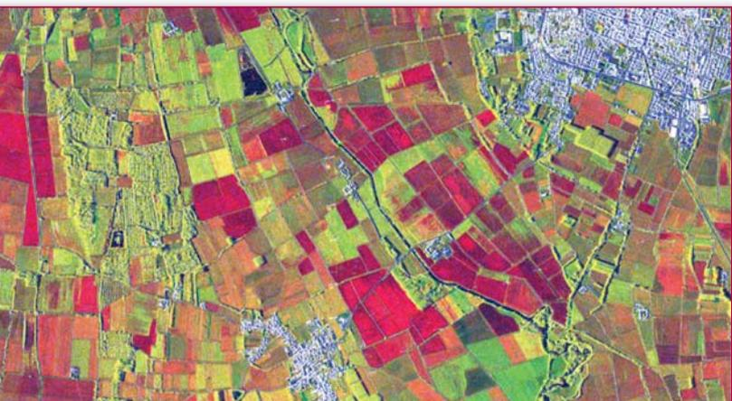
Figura 4 - Immagine a colori derivata da una coppia COSMO interferometrica sull'area di Pavia 30 settembre 008 e 20 maggio 2009 da notare in rosso l'ampiezza del segnale (settembre) verde l'ampiezza del segnale (maggio), blue coerenza interferometrica.
