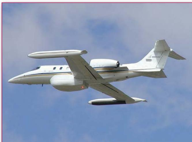
*Intermap ha raccolto i dati del programma NEXTMap Europe con un radar SAR interferometrico montato su Learjet. Volando ad un'altitudine di circa 10.300 metri, gli aerei hanno collezionato i dati con passate di 200km.*
