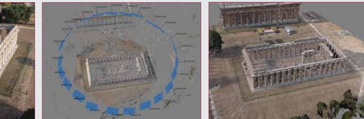
Figura 3 - Orientamento di un blocco UAV acquisito attorno ad un monumento archeologico e modello digitale derivato con tecniche di image matching.
