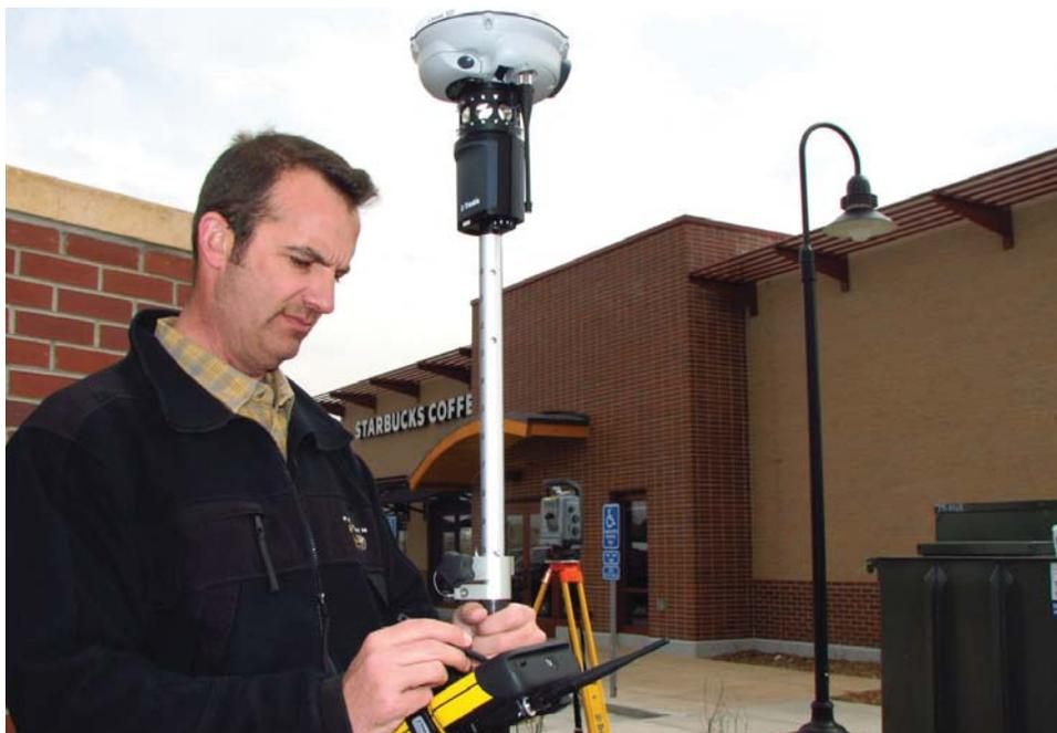
collegato tutte le fasi del progetto al lavoro sul campo. La configurazione del rover Trimble SI Rover™ (Spatial Imaging Rover) consente l'integrazione sul campo di nuvole di punti e misure GNSS. Ancora meglio, ci ha consentito di eseguire le due cose contemporaneamente.
