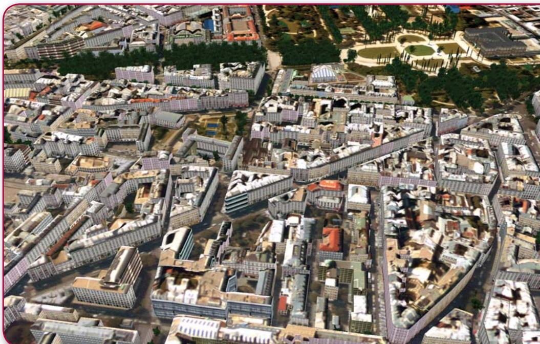
Figura 3 - Primo piano del modello 3D di Parigi generato automaticamente da LandSIM3D con dati GIS forniti dal Geographic National Institute.
