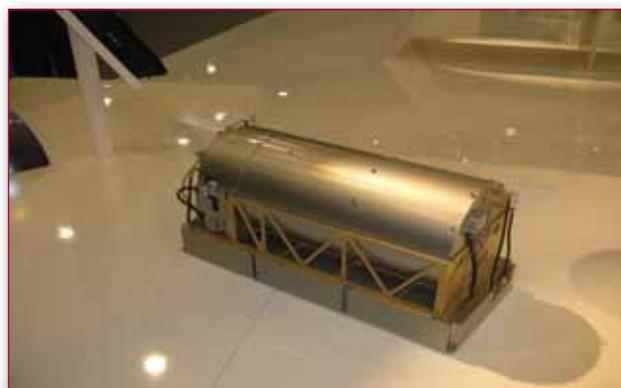
L'orologio atomico PHM (Passive Hydrogen Maser), il più stabile orologio atomico spaziale mai costruito, installato a bordo di GIOVE-B (GALILEO) per i calcoli di posizionamento.
