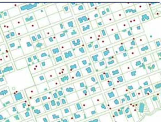
Figura 6 - Stralcio del rilievo catastale con i centroidi, in posizione baricentrica, derivati dalle impronte degli edifici sconosciuti al catasto.
