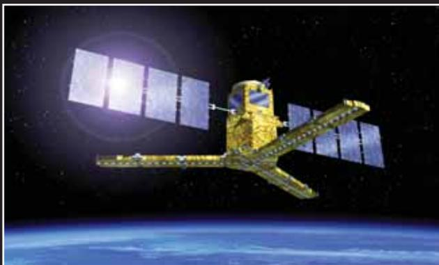
Il satellite SMOS in orbita. Si notano le tre braccia delle antenne del radiometro. Credits: ESA - P. Carril
