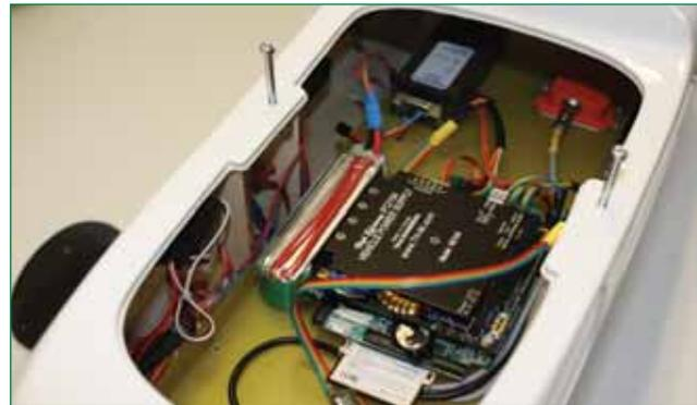
Dettaglio del sistema di acquisizione a bordo del velivolo.
