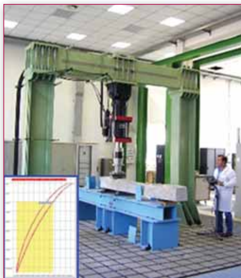
Macchina per prove dinamiche e di fatica ( F=750\text{ KN} e frequenza max 10 Hz).
