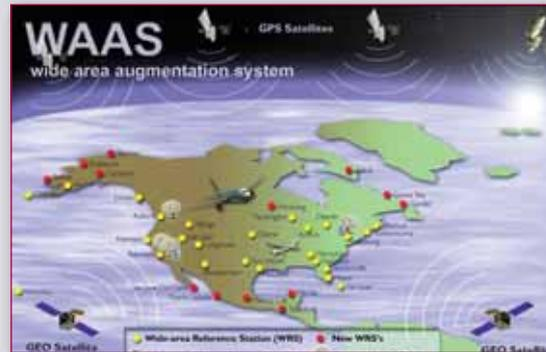
Dislocazione delle infrastrutture del WAAS, il sistema SBAS del Nord America.
