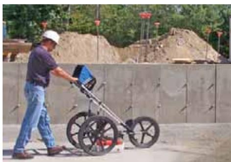
Strumenti per rilievi non distruttivi del sottosuolo: georadar con antenne a frequenza diversa per ogni applicazione, sismografi, geoelettrica, logger da foro, inclinometri...
