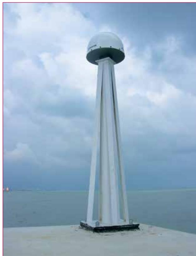
Fig. 3 – Antenna Topcon CR-G3 sul tetto della Stazione Mareografica di Porto Garibaldi.
