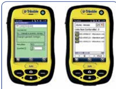
Figura 6 – Palmari Trimble JUNO utilizzati per il rilievo delle non conformità.
