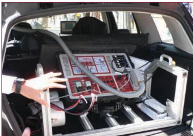
Fig. 3 - Computer con i dischi per il salvataggio dei dati e l'alimentazione alloggiato nel bagagliaio
